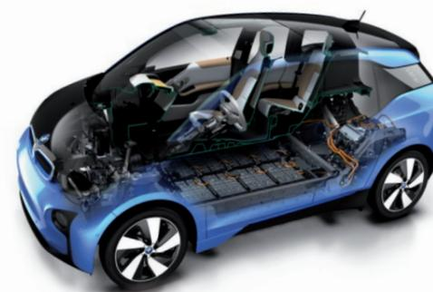
Figure 3 : Voiture tout électrique utilisant des composites à fibres de carbone.
