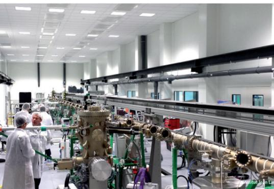
Figure 3 : Photo du Tube Davm implanté à l'Institut Jean Lamour sur le Campus ARTEM. Sur une longueur de 70 mètres, 30 équipements d'élaboration et de caractérisation de matériaux sont connectés sous ultra-vide (c'est à dire sous un vide de quelques 10<sup>-10</sup> mbar, équivalent au vide interplanétaire).
