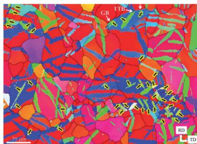
Figure 3: Observation par EBSD des macles d'extensions primaire et secondaire dans un alliage de magnésium.
