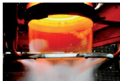
Figure 8 : Assiette observée en cours de fibrage de laine de verre d'isolation (Saint Gobain).
