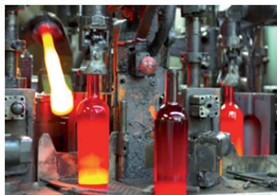
Figure 7 : Procédé de soufflage automatique pour l'élaboration de bouteilles (Saverglass).
