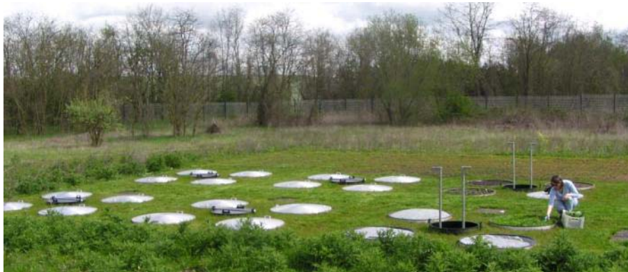
Colonnes lysimétriques équipées pour l'étude de la dynamique des polluants, l'évaluation des risques et le traitement des sols pollués
