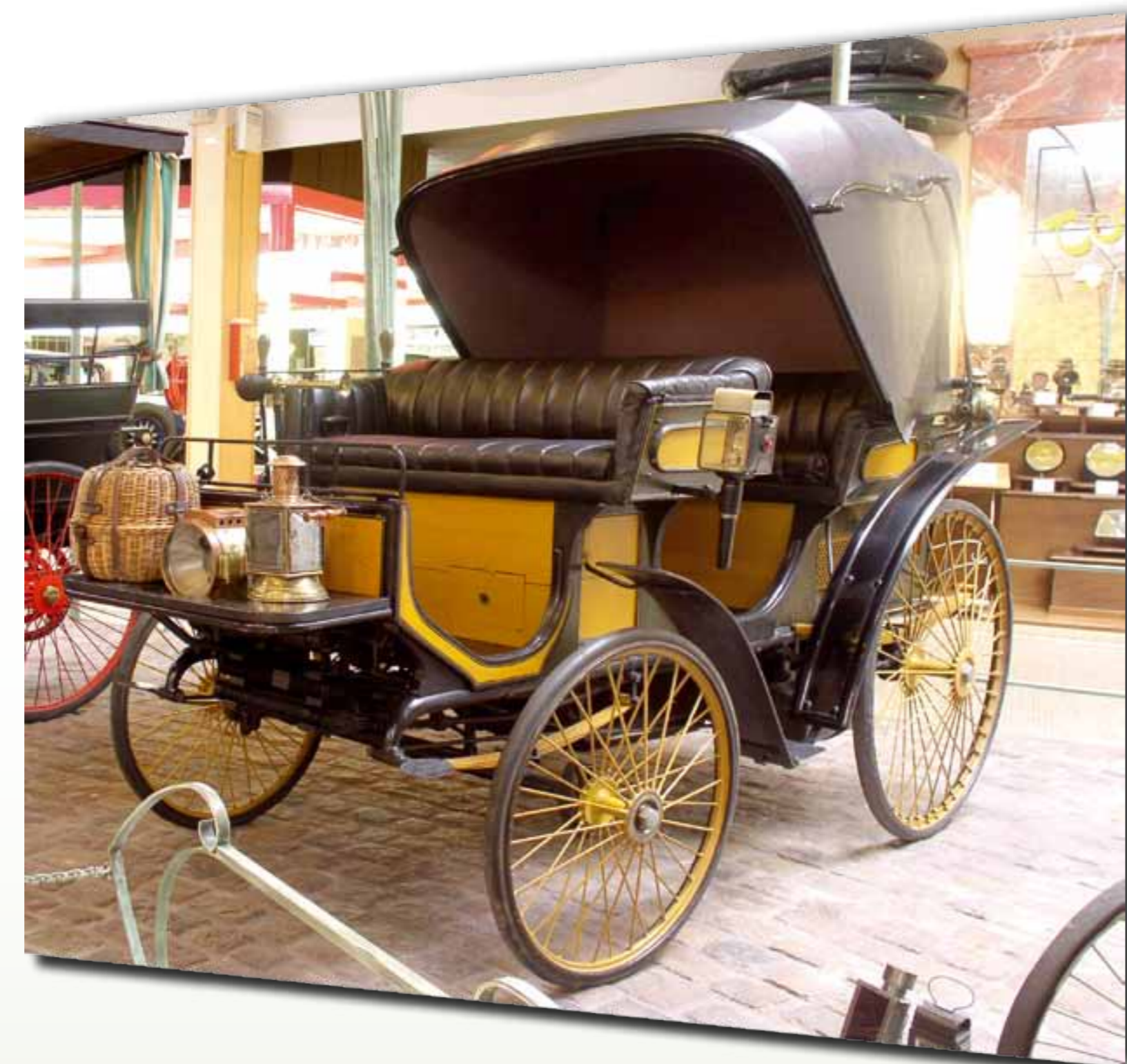
Voiture Peugeot « Type 8 » de 1894 à carrosserie Victoria. Moteur à liquide combustible 1283 cm 3 V2, 4 soupapes.
